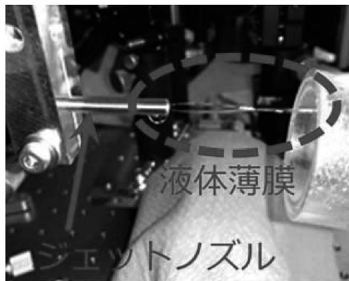
図1 液体薄膜生成の様子。特殊なジェットノズルから高压で液体を噴出すると、厚さ 100 ミクロンの液体薄膜が安定して形成できる。この液体薄膜部分にレーザーを照射し、アブレーションを誘起、テラヘルツ波を発生させる。
